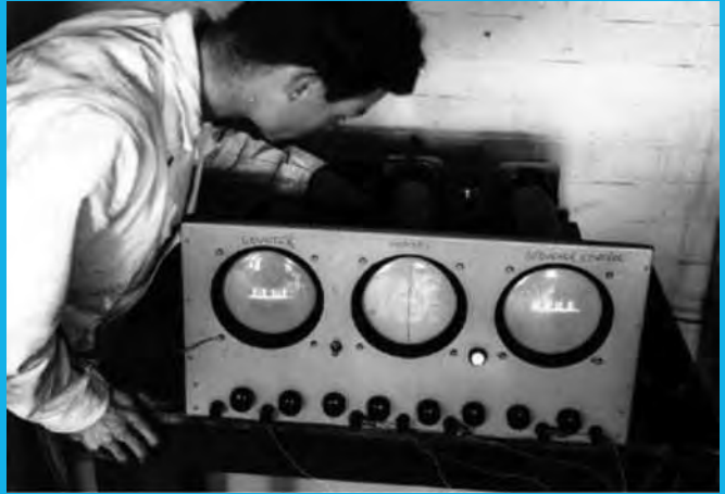
FIGURA 1: MODELO DE DISPLAY TRIPLO DE SAÍDA UTILIZADO PELO COMPUTADOR EDSAC. FOI NESTE TIPO DE TELA QUE OS GRÁFICOS DE NOUGHTS AND CROSSES ERAM EXIBIDOS AO JOGADOR. FONTE: HISTORY OF COMPUTERS
