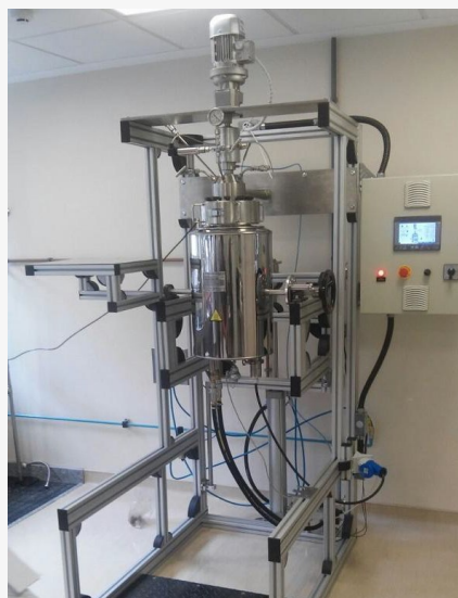
Reator utilizado para aumento de escala da produção de óleo
