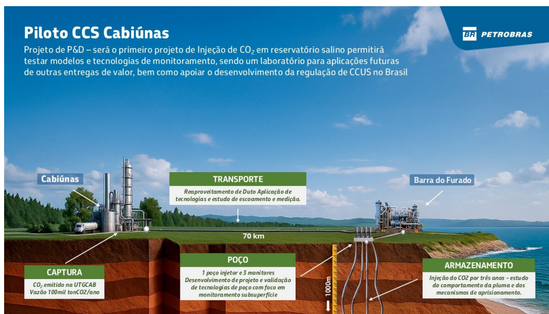
Figura 12: Representação esquemática do Piloto de CCS Cabiúnas – São Tomé
