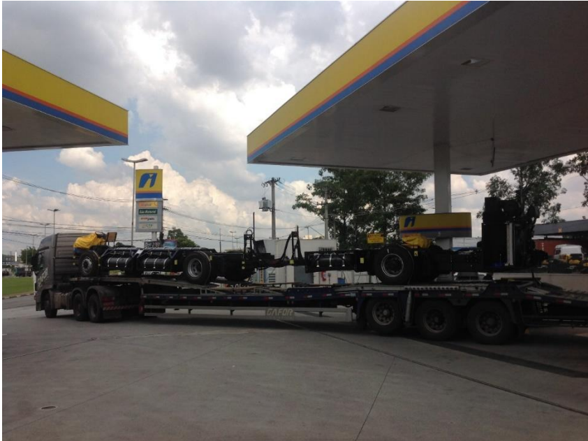
10 Cilindros Tipo 4 Volume: 1460 litros
