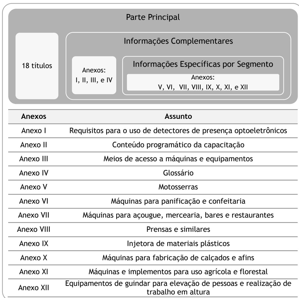
Figura 01 - Estrutura da nova redação da NR 12 com a lista de anexos e os respectivos assuntos abordados.
