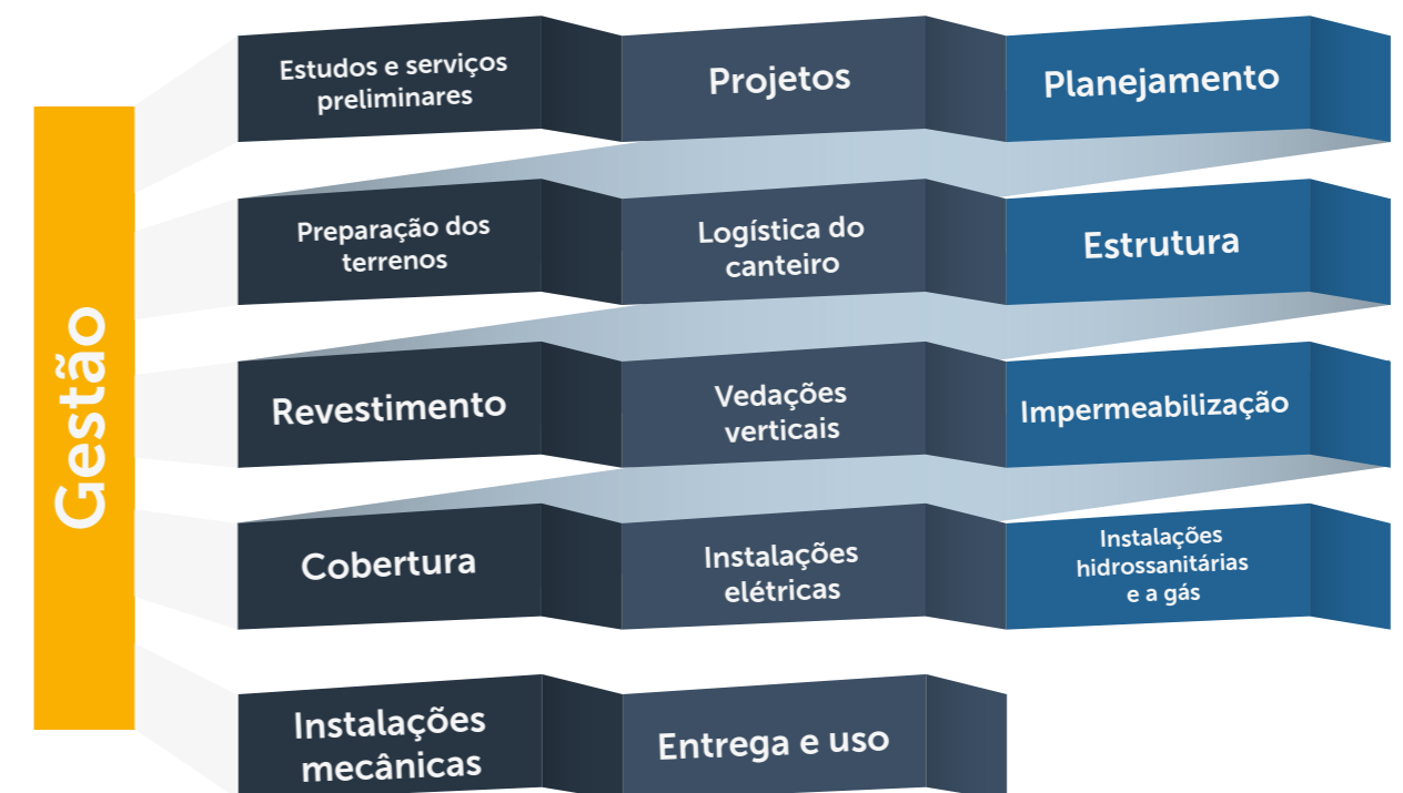
Figura 2 | Etapas da construção de edifícios
